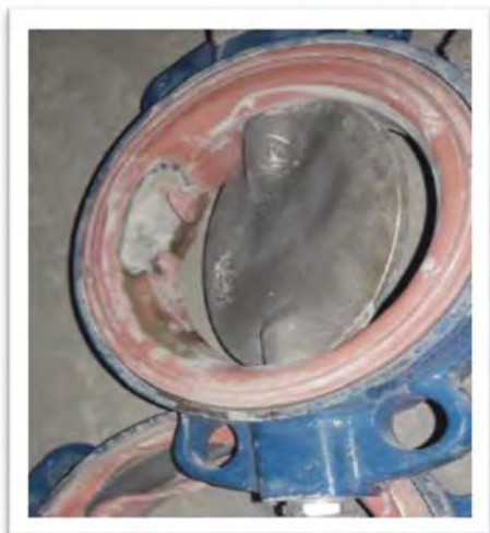
Рис. 14. Дисконная заслонка, вышедшая из строя
