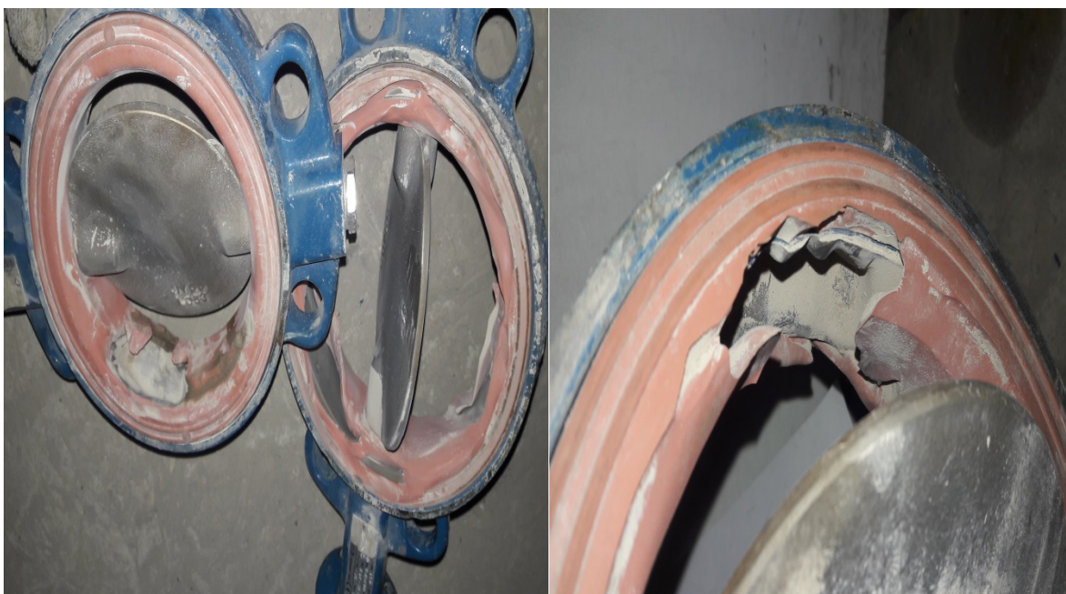
Рис 1. Отработанные межфланцевые дисковые затворы (высокопрочный чугун, полиуретановые манжеты). Процесс: пневмотранспорт фосфоритной муки.
