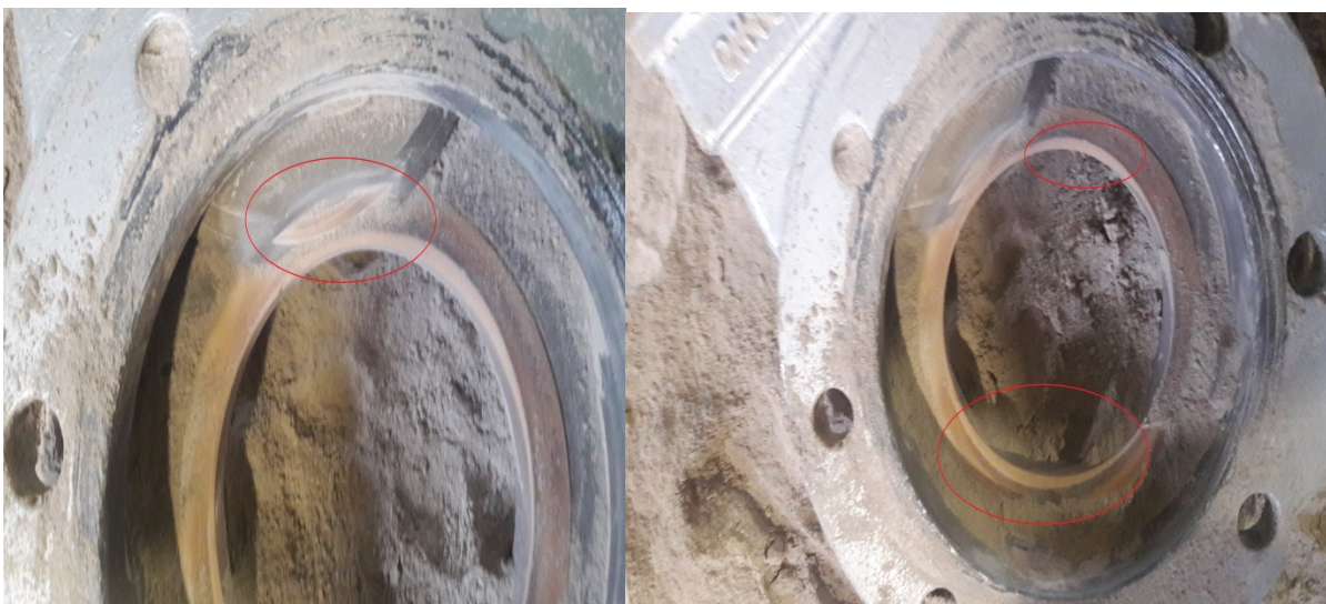
Рис.3 Керамические ножевые шиберные задвижки Лортэкс Эко. Отработка 60 дней. Инспекция.
